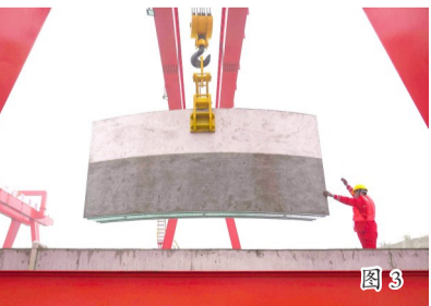
图1图2 3月1日,在蔡家智慧新城中铁十四局重黔铁路站前2标管片场,工人在生产重庆长江隧道盾构管片。
