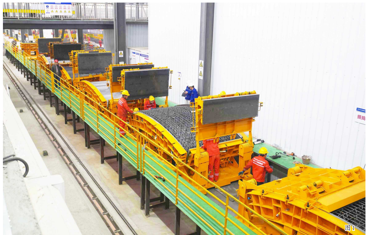
图1图2 3月1日,在蔡家智慧新城中铁十四局重黔铁路站前2标管片场,工人在生产重庆长江隧道盾构管片。
